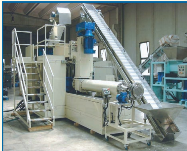
Vista generale della linea di finissaggio per saponi speciali completamente automatizzata Omron.
